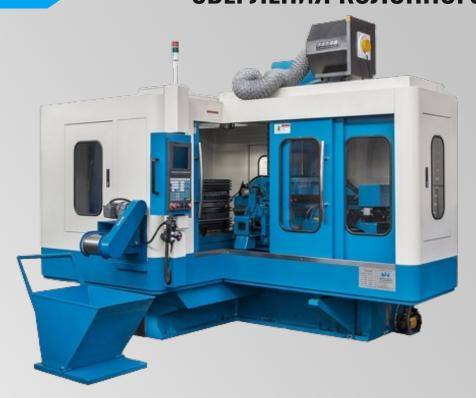
Горизонтальные станки для глубокого сверления колонного типа
